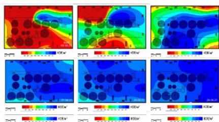
Рис. 5. Графический метод представления изменений концентрации КОЕ в воздухе пищевого производственного цеха в результате работы приборов «ТИОКРАФТ»
