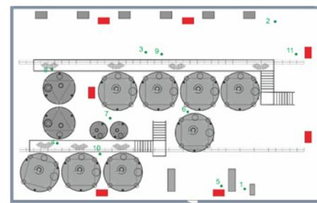
Рис. 6. Пример расстановки приборов «ТИОКРАФТ» в пищевом производственном цеху
