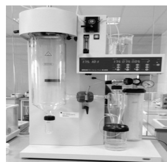
Рис. 1. Схема установки распылительной суши а) принципиальная схема: 1 – форсунка; 2 – нагреватель; 3 – распылительная камера (цилиндр); 4 – циклон; 5 – фильтр; 6 – аспиратор. б) внешний вид
