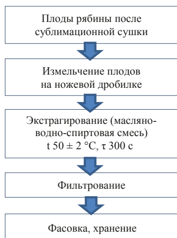
Рисунок 2 – Технологическая схема получения экстракта биологически активных веществ из плодов рябины обыкновенной
