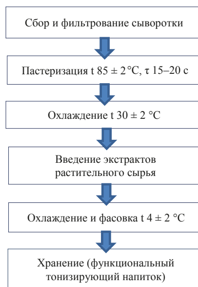
Рисунок 1 – Технологическая схема получения тонизирующего напитка на основе молочной сыворотки и БАВ растительного и лекарственного сырья
