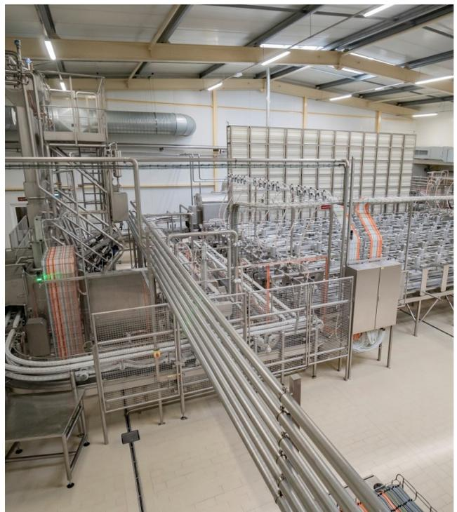
Общий вид сырного цеха, включающий: колонны для формования сыра, индивидуальные прессы окончательного прессования, склад форм и крышек, мойка форм, транспортеры форм
