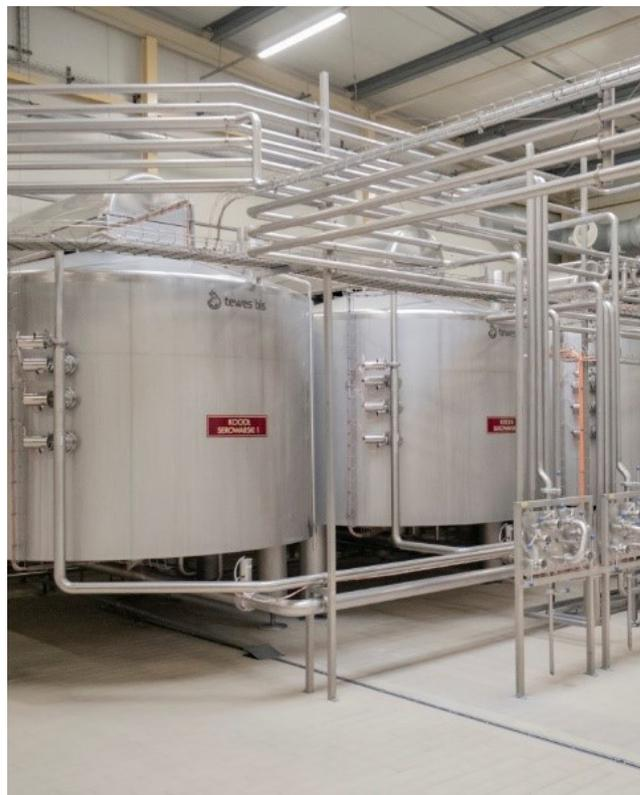
Сыроизготовители с боковой системой отбора сыворотки и автоматическим управлением, возможностью использования различных рецептов для производства разных видов сыра
