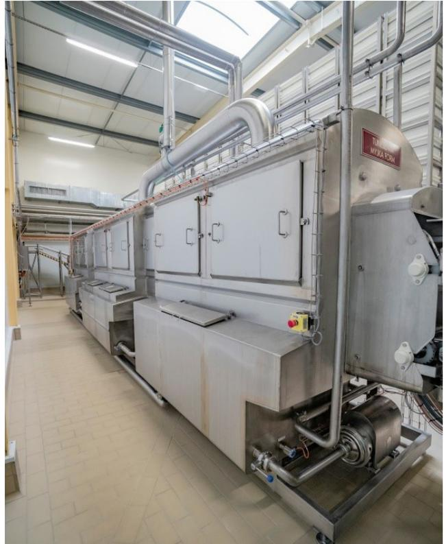
Мойка форм и крышек, включающая предварительное полоскание, непосредственно мытье, конечное полоскание чистой водой
