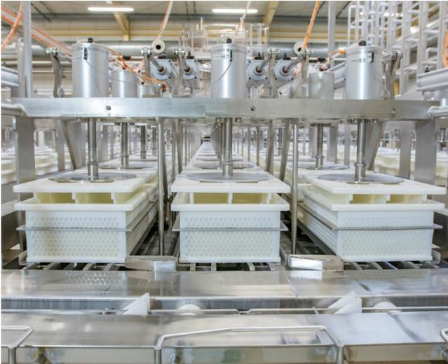
Пресс окончательного прессования сыра с системой автоматической регулировки времени и силы прессования единичных головок сыра
