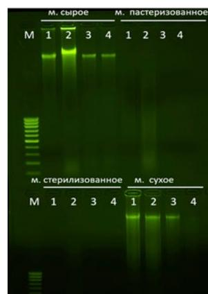
Рисунок 1. Электрофореграмма типовых результатов выделения суммарной ДНК из сырого, пастеризованного, стерилизованного и сухого козьего молока наборами № 1–4. М – маркер («100 + bp DNA Ladder»)
