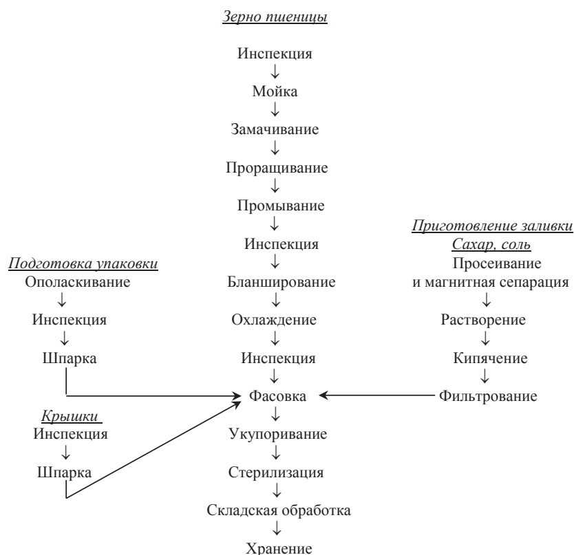
Рис. 1 Общая схема производства консервов из пророщенного зерна пшеницы
